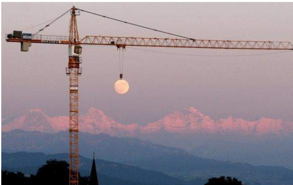
Illustration 16: grue : archétype de structure légère et robuste basée sur la poutre treillis
